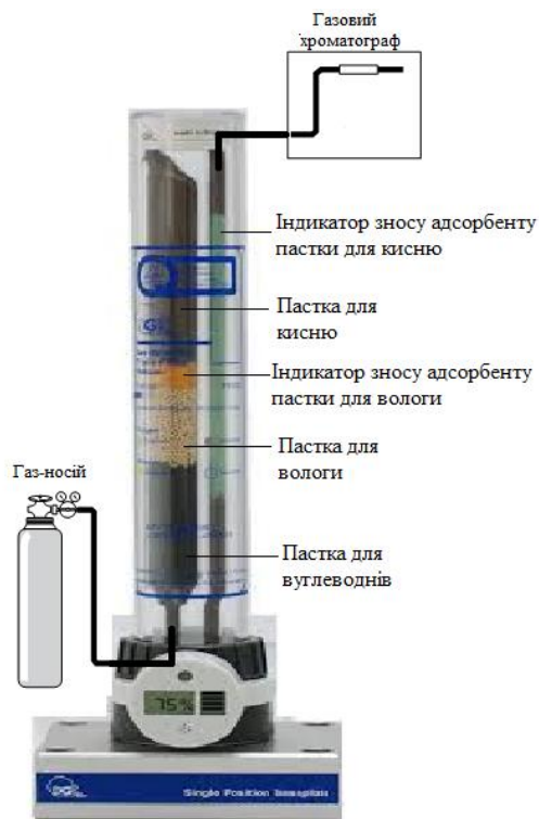
Рис. 3. «Об'єднаний фільтр», що використовують для очищення газу-носія
